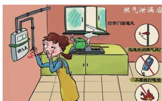
十二、禁用明火检查漏气,以免发生事故。用户若发现有天然气臭味,可先用肥皂水刷天然气管道接头或设备零件,如有漏气就会吹出肥皂泡。千万不能用明火检查是否有漏气情况,以免发生事故。
