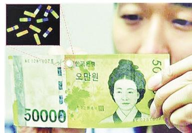
由美国麻省理工学院的科学家开发出的一种防伪颗粒，有望最大限度减少非法贸易，让假冒商品立即现出原形。这种防伪颗粒由一种聚合物制成，每个长约200微米，由不同条纹的纳米晶体组成，这种晶体被称为稀土转换纳米发光晶体。晶体掺杂有镉、钆、钇、铕等金属元素，当暴露在近红外光下就会发出各种颜色的可见光。不同颜色的排列顺序可以让每个颗粒具有唯一性。通过改变这些元素的比例，研究人员可以让晶体发出任何颜色的可见光。使用这种方法，研究人员可以生成数量庞大的独特标签。
