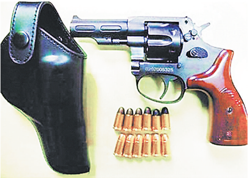
▲2005式警用9mm转轮手枪是我国第一代自主研发的警用手枪,全长186mm。
