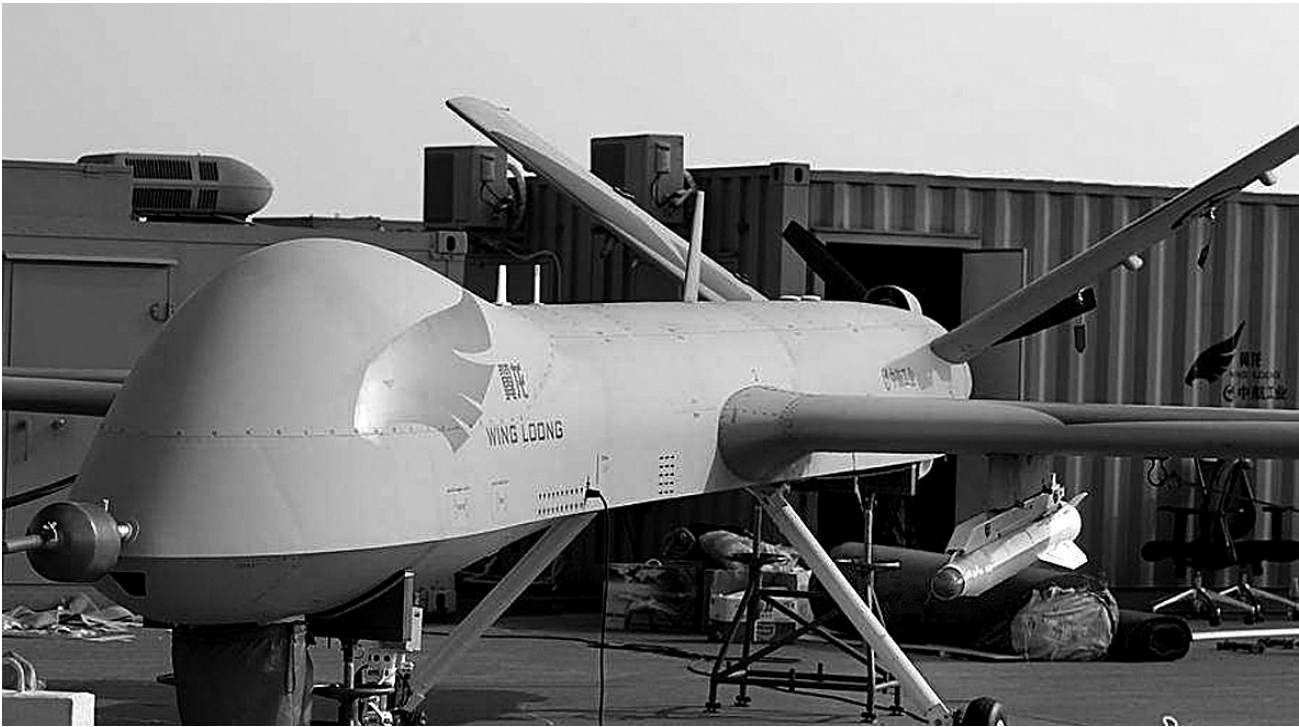
▲2012年11月12日,珠海航展开幕前一天,被迷彩“外套”包裹得严严实实的翼龙无人机“真身”显露真容。这款无人机由成都飞机设计研究所研制。相关资料显示,“翼龙”的最高飞行高度为5300米,航程可达4000公里,最大续航时间为20个小时。作为兼具侦察—打击一体化功能的新型无人机,翼龙可同时携带侦察、激光照射/测距、电子对抗设备和小型空地打击武器,执行监视、侦查及对地攻击任务。
