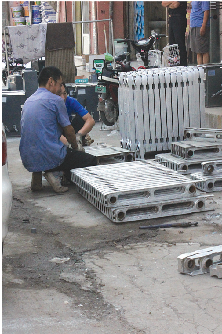
一商户正对旧暖气片进行翻新
