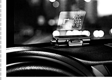
这是一款可与智能手机导航应用配合的产品，可放置在前面板上，而它能通过蓝牙无线连接到手机上，并将导航数据投影到驾车者的视野范围内。
