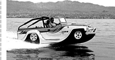
这款号称世界上最快的吉普车，能够直接从陆地开到水中，并在15秒内由车变成船。它在水里的时速达到45英里，几乎与普通的高速游艇不相上下。它还装配有定制的3.7升V6引擎、玻璃钢船体和轻量化的铬钼钢底盘。
