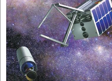
美国正在研发一种太空清扫车，实际上是一个安装了200张电磁网的航天器，可以捕捉近地轨道上的空间碎片，清洁太空。按照设计，12个太空清扫车经过7年时间，将能捕获近地轨道上已被识别的2465个两公斤以上碎片。一旦捕获目标，太空清扫车将把垃圾打包投掷到南太平洋。
