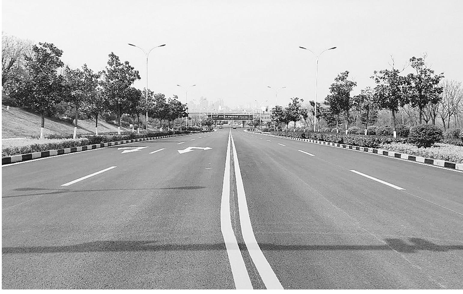
连日来,薛城区实施了长江路高架段(太行山路至德仁路转盘)提升改造工程。截至目前,道路工程累计完成预埋过路管线4道,沥青灌缝5010米,整修路沿石180米,路面摊铺AC-13沥青砼、结合油60000平方米。图为4月7日,提升改造工程后的长江路。(刘品 张艳 摄)
