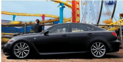
以动感的IS房车为基础,Lexus在ISF引擎盖下塞入5.0升V8引擎,压榨出400匹的最大马力,最大扭矩也来到48.4公斤米;搭配世界首款八速Sport Direct Shift变速箱,强大的性能输出使ISF能在4.9秒内完成0到100km/h的加速动作。同时左右四排性能尾管、Brembo刹车系统和BBS提供的19吋抛光大脚铝圈,也再次突显IS-F的性能能力。
