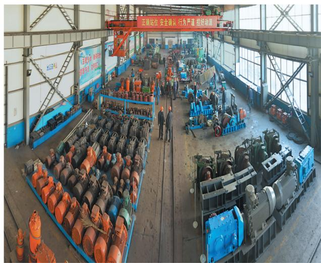
高庄煤业公司机修厂持续开展“勤俭节约、降本增效”主题实践活动，引导员工牢固树立过“寒冬”、过“常冬”的思想，变“被动式维修”为“主动式检修”，加大废旧设备的回收复用力度，提高自修自制能力，大力压缩修理费用，近两个月，就通过回收复用和修旧利废节约资金16万余元。（耿玉鸣 王君 摄）
