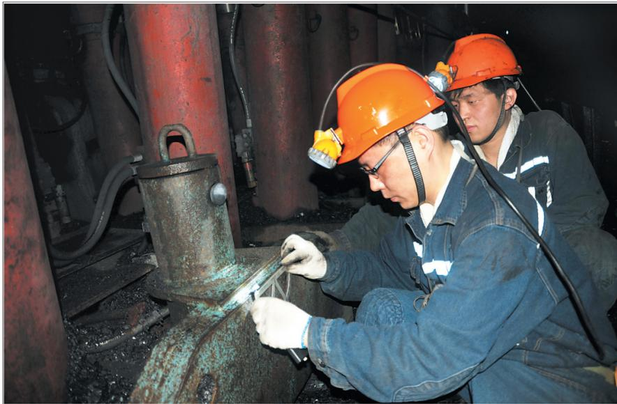
高庄煤业公司围绕矿井安全生产实际,坚持一切工作从设计源头上严把关卡,严把工程质量毫米关,所有工程用尺子和量具说话,实行严格交接、动静验收和签字制度,切实把安全质量管理工作细化、量化、具体化,全力确保年终安全生产。图为施工人员使用坡度轨测量支架倾斜度,确保支架状态完好。(甄方方 摄)
