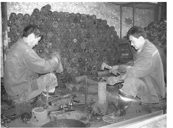
丰源集团赵坡煤矿团总支积极发动团员青年发挥聪明才智,广泛开展节俭降耗青年当先、修旧利废青年当先、质量标准青年当先等降本增效活动,引导团员青年为企业发展做贡献。图为青工正在修复从井下回收来的皮带托辊。(李甲鹏 摄)
